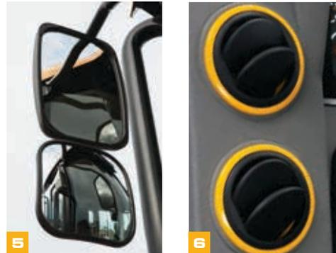
6 Das komplett neu entwickelte Belüftungssystem besticht durch neun Belüftungsschlitze und sechs Luftdüsen für den Bediener, sodass jederzeit eine gute Sicht und der Komfort des Fahrers gewährleistet sind. Zudem wurde der Geräuschpegel des Systems gesenkt.
