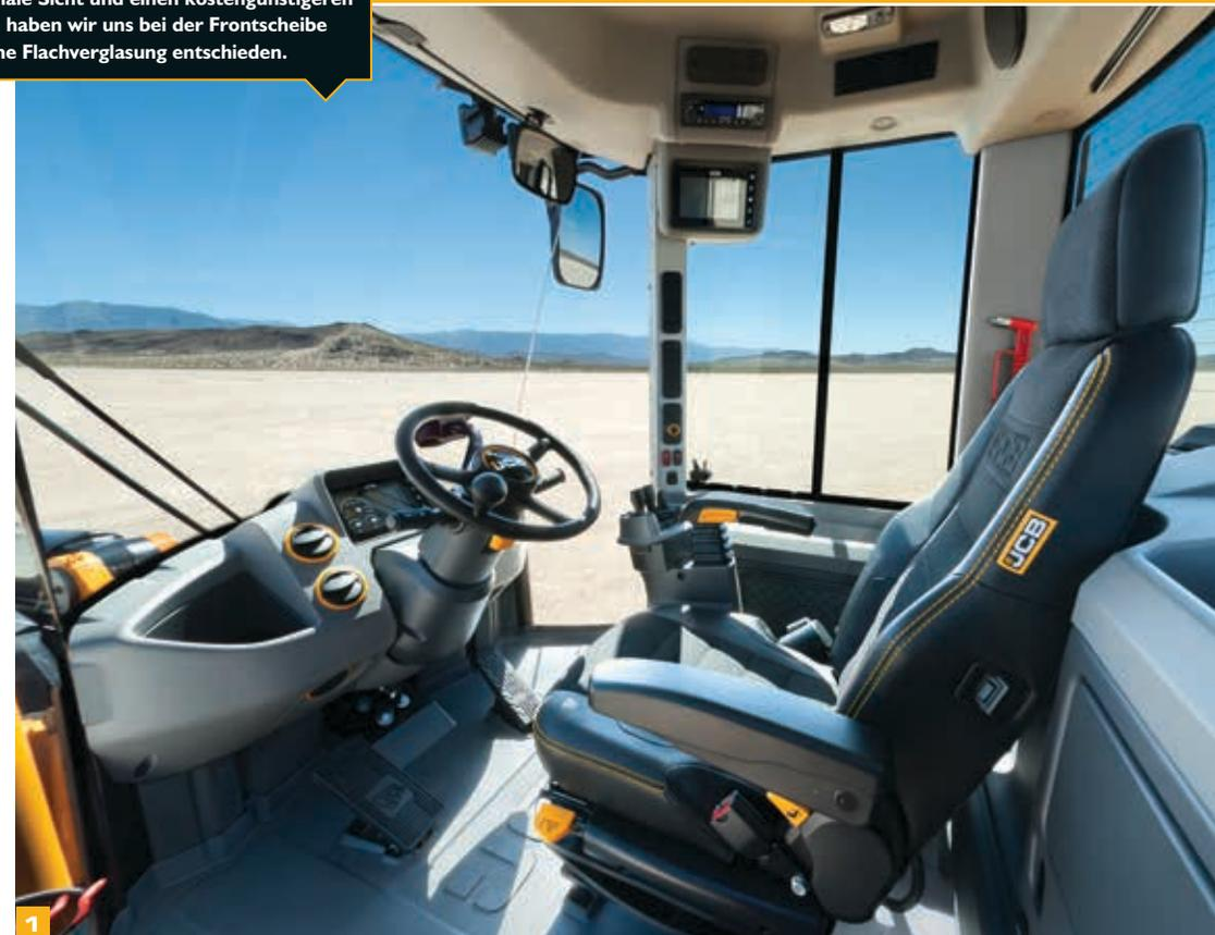
Der Geräuschpegel in der Kabine beträgt unglaublich niedrige 68 dB(A): Dies ist so leise, dass Sie kaum hören, dass der Motor läuft.
