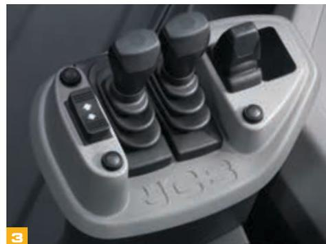
**3** Die Bedienung des Radladers ist jetzt einfacher denn je – alle Bedienelemente sind am Sitz befestigt und gehen sogar mit dessen Federung mit.
