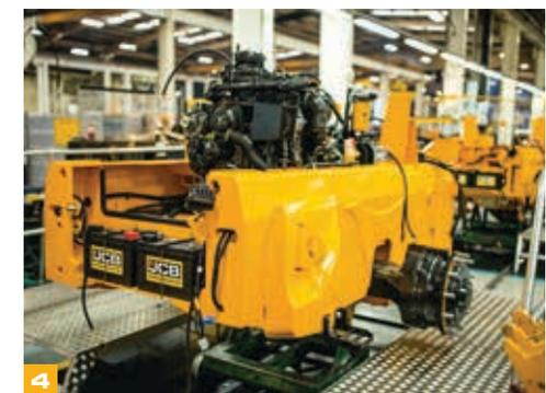
Das Knickgelenk des JCB 457 ist als Schwerlast-Kastenprofil konstruiert und ist so deutlich robuster als eine einzelne verschweißte Platte. Die Lenkzylinder sind weit oben angebracht und damit gut vor Stößen und Beschädigungen geschützt.
