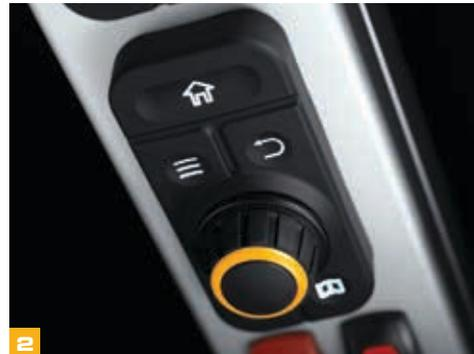
**2** Die Verwendung der einfachen, dedizierten Menüführung im JCB 457 erfolgt über einen intuitiv zu bedienenden Drehschalter.
