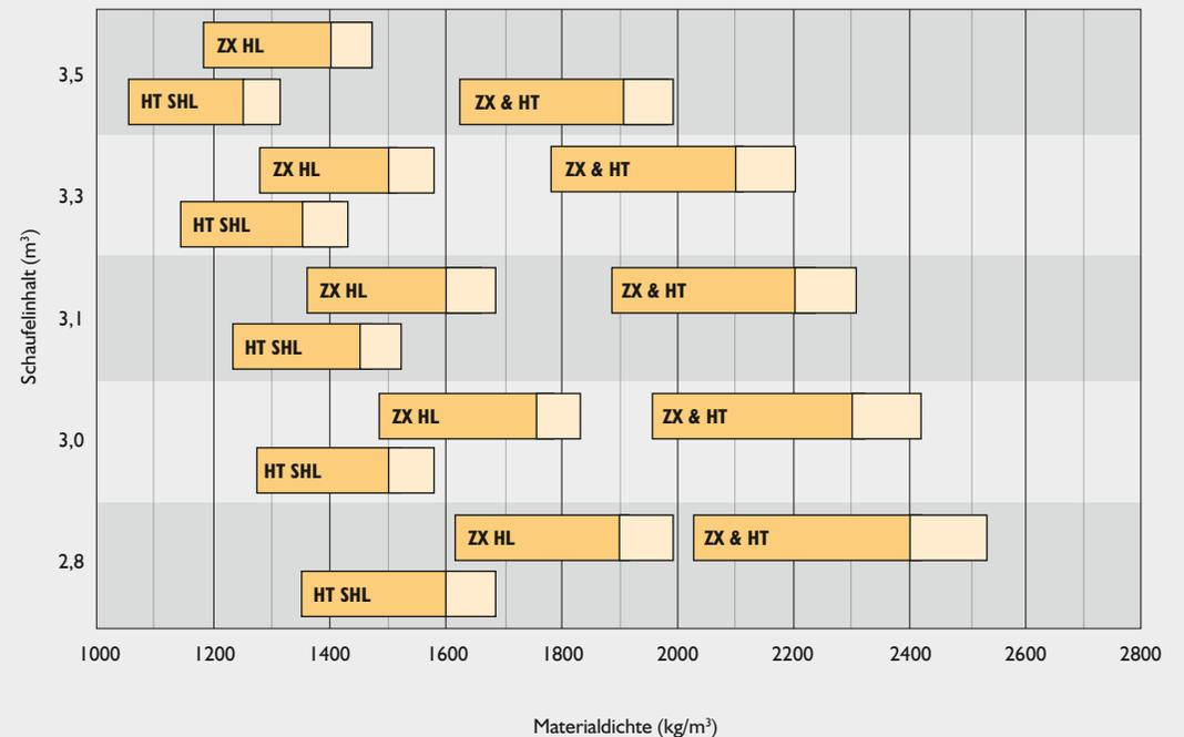
HT = Standard-Hubgerüst HL = High-Lift-Hubgerüst SHL = Super- High-Lift-Hubgerüst ZX = Z-Kinematik
