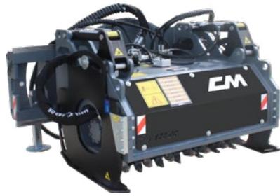
Die selbstnivellierende Kaltfräse wird in 8 Modellen mit einer Breite von 25 bis 100 cm hergestellt. Es eignet sich zum Abtragen des oberen Straßenbelags, des Zements auf Plätzen, zum Abkratzen von Fels bzw. zum Erstellen von Querungen oder Spuren, wo gepflastert wird. Es kann schnell und einfach auf Kompaktladern, Baggerladern und hydrostatischen Radladern eingesetzt werden.
